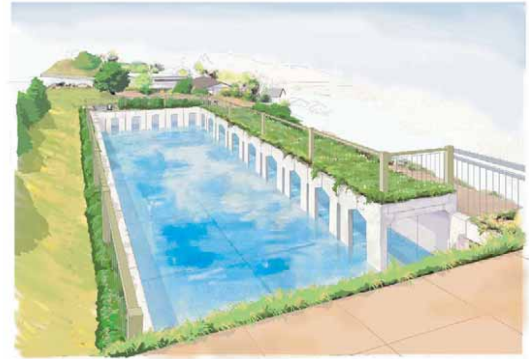
・半地下式雨水調整池
