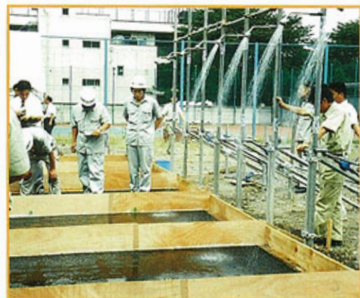
試験体への散水状況
