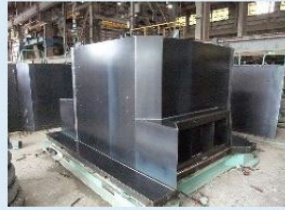
型枠は鋼製、製品の長さ調整や斜切り加工も型枠で行います。
