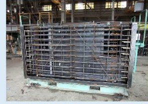
型枠は鋼製、製品の長さ調整や斜切り加工も型枠で行います。
