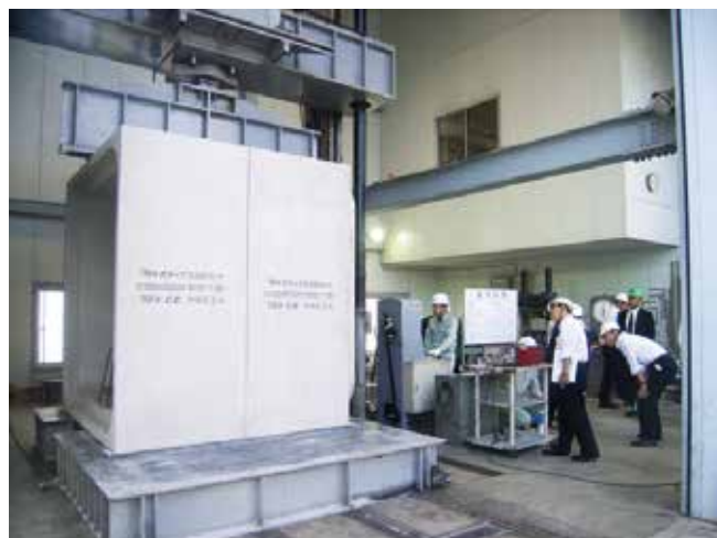
載荷試験状況（本体部の確認）
