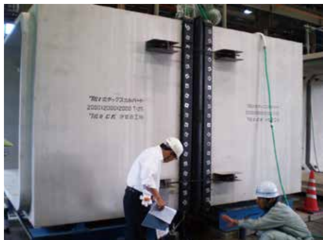
水密試験状況（継手部の確認）
