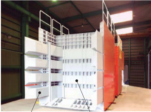
▼オープンシールド機(NOSI型)(切羽掘削部):前方から
